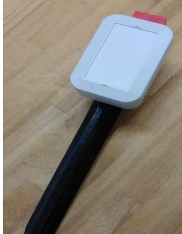
ミテテル傾斜計(法面監視)
