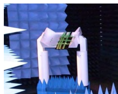
電波暗室での特性確認イメージ
