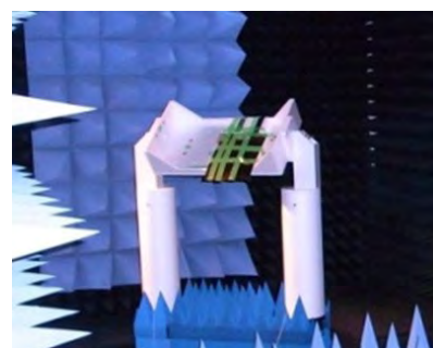
電波暗室での特性確認イメージ
