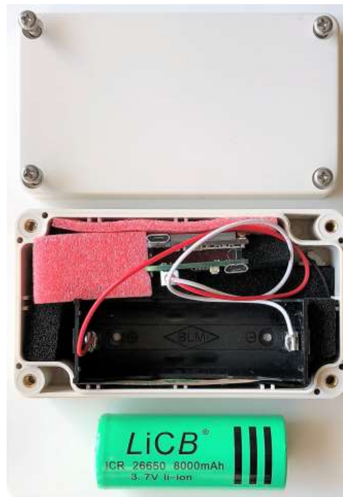
上記写真の8000mAhのリチウムイオン電池で約4ヶ月ほど稼働し続けます
