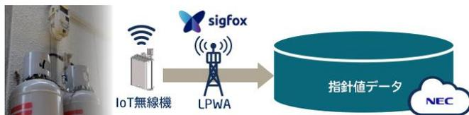
IoT無線機からLPWA（消費電力が低く、低コストでIoTに最適な通信技術）を介してクラウドへ指針値のデータを送信
